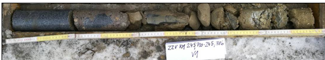
Obr. č. 2 - diagnostický vrt V1 do dříku zdi - v km 245,772
