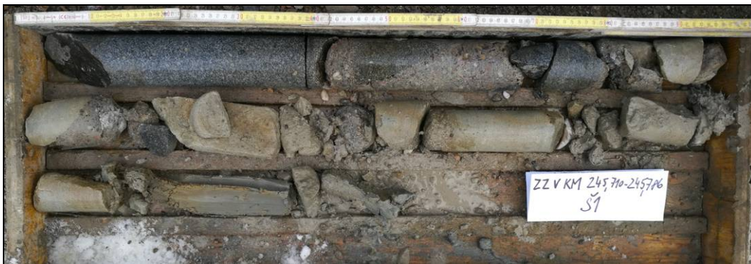
Obr. č. 1 - diagnostický vrt Š1 do dříku zdi - v km 245,771
